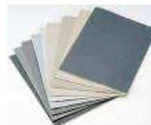
carrosserie. Il faudra poncer la surface avec des grains de plus en plus fins jusqu'à disparition visuelle complète. Commencer avec du 400, puis 800, puis 1200. Mouillez bien et croisez le sens du ponçage entre chaque changement de papier, les rayures de l'ancien ponçage doivent être supprimées avec le nouveau papier.
