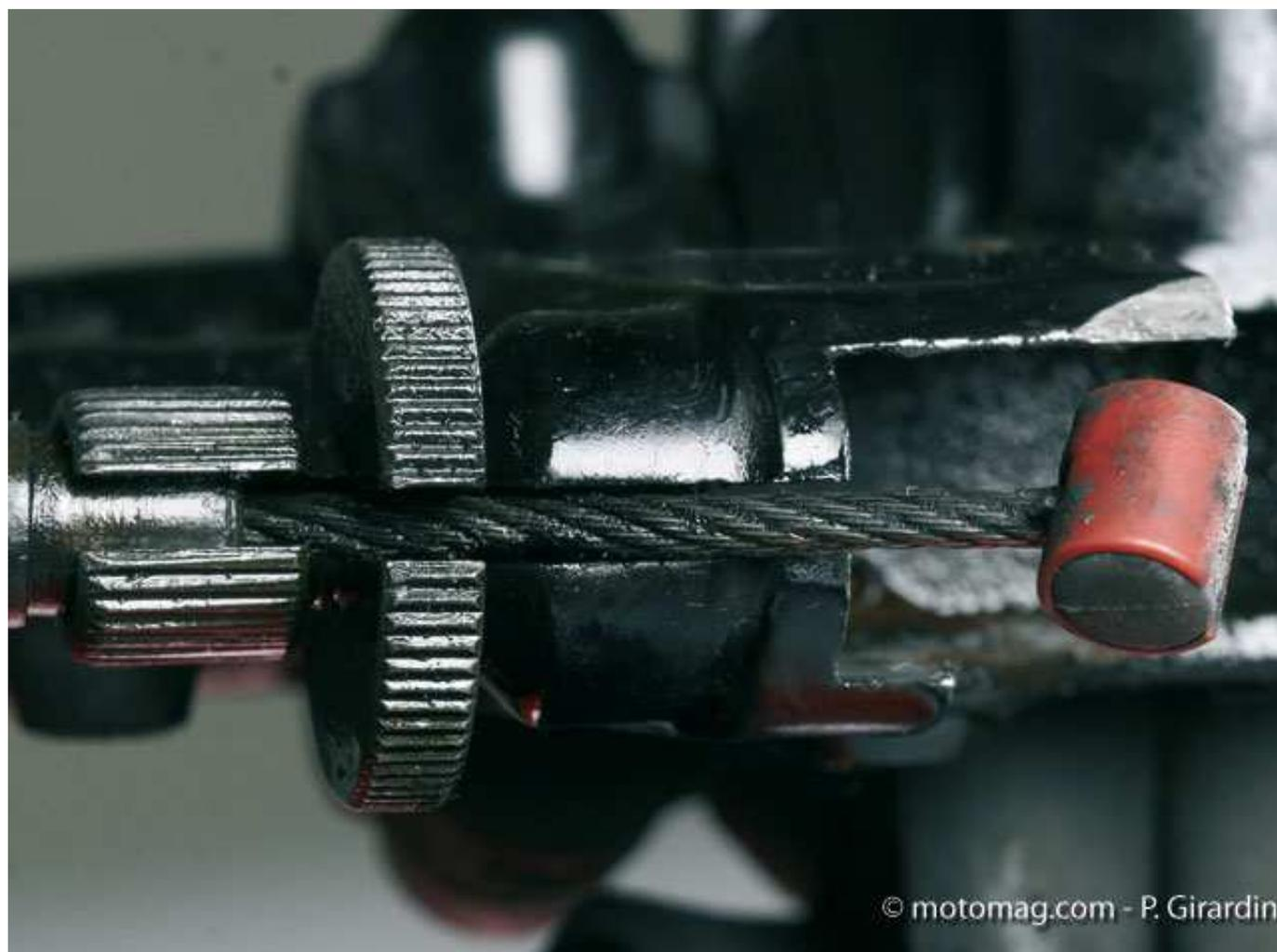
Avant de démonter ou remonter un levier actionnant un câble, donner du mou à ce dernier en rentrant au maximum sa molette de réglage. Si cela ne suffit pas pour retirer le câble ou le levier, donner également du mou au second réglage au niveau du moteur.
