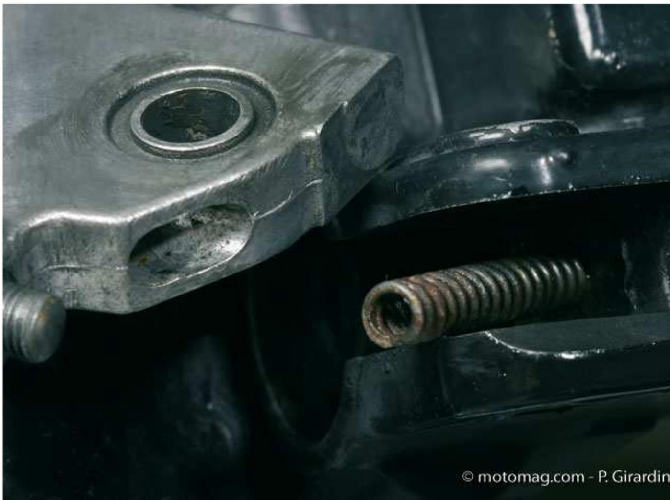
**3** Avant de démonter ou remonter un levier actionnant un câble, donner du mou à ce dernier en rentrant au maximum sa molette de réglage. Si cela ne suffit pas pour retirer le câble ou le levier, donner également du mou au second réglage au niveau du moteur.
