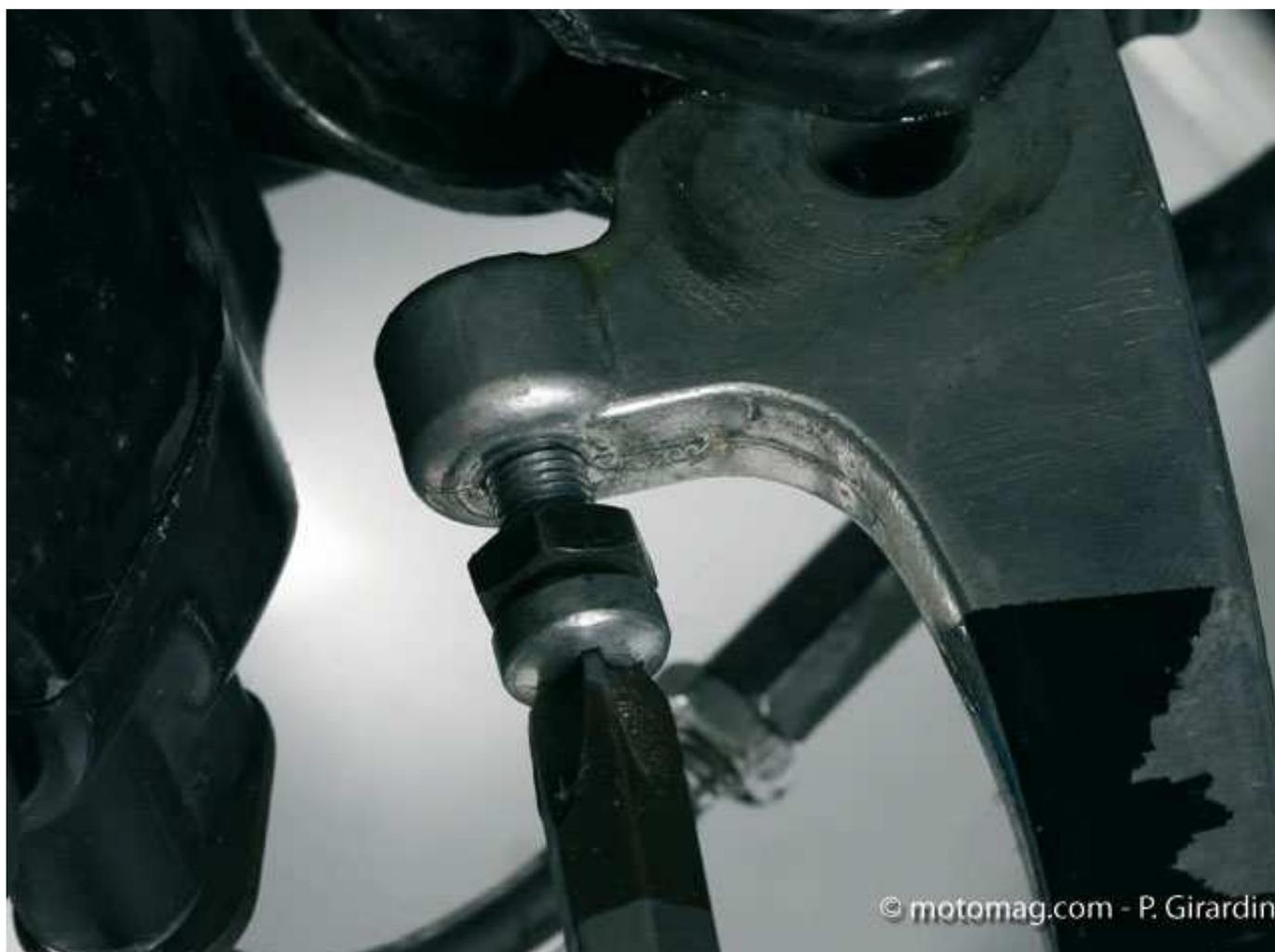
Certains leviers de freins comportent ce type de vis, qui sert à ajuster la garde, c'est-à-dire le jeu nécessaire avant que le levier n'actionne le piston du maître-cylindre. Le réglage à ce niveau est primordial, car un manque de jeu ferait freiner en permanence.
