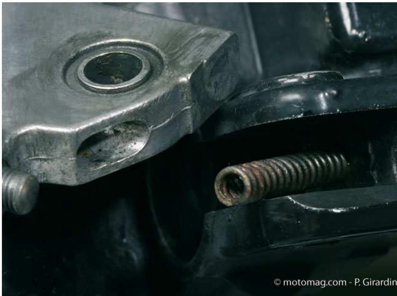
Dans l'épaisseur de certains leviers de frein est parfois logé un petit ressort qui le ramène en position de repos. Au démontage, ce ressort peut rester dans la cocotte, mais aussi tomber à terre... Vérifiez sa présence au remontage. Une goutte de graisse facilite son maintien pendant le positionnement du levier neuf.
