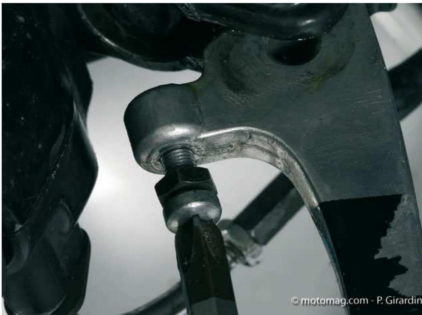
**5** Un graissage des parties frottantes est immédiatement profitable à la précision de la commande. Il évite aussi l'usure ou le grippage futurs du levier, synonymes de dureté, de jeu, et de perte de « feeling ». Disposez une pointe de graisse sur le logement de l'axe, et sur la partie en contact avec le piston du maître-cylindre.
