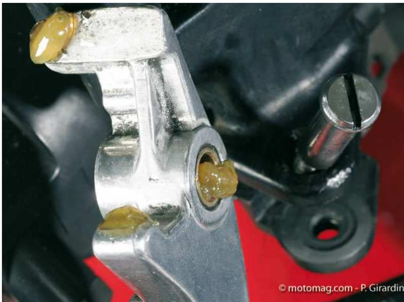
Un graissage des parties frottantes est immédiatement profitable à la précision de la commande. Il évite aussi l'usure ou le grippage futurs du levier, synonymes de dureté, de jeu, et de perte de « feeling ». Disposez une pointe de graisse sur le logement de l'axe, et sur la partie en contact avec le piston du maître-cylindre.
