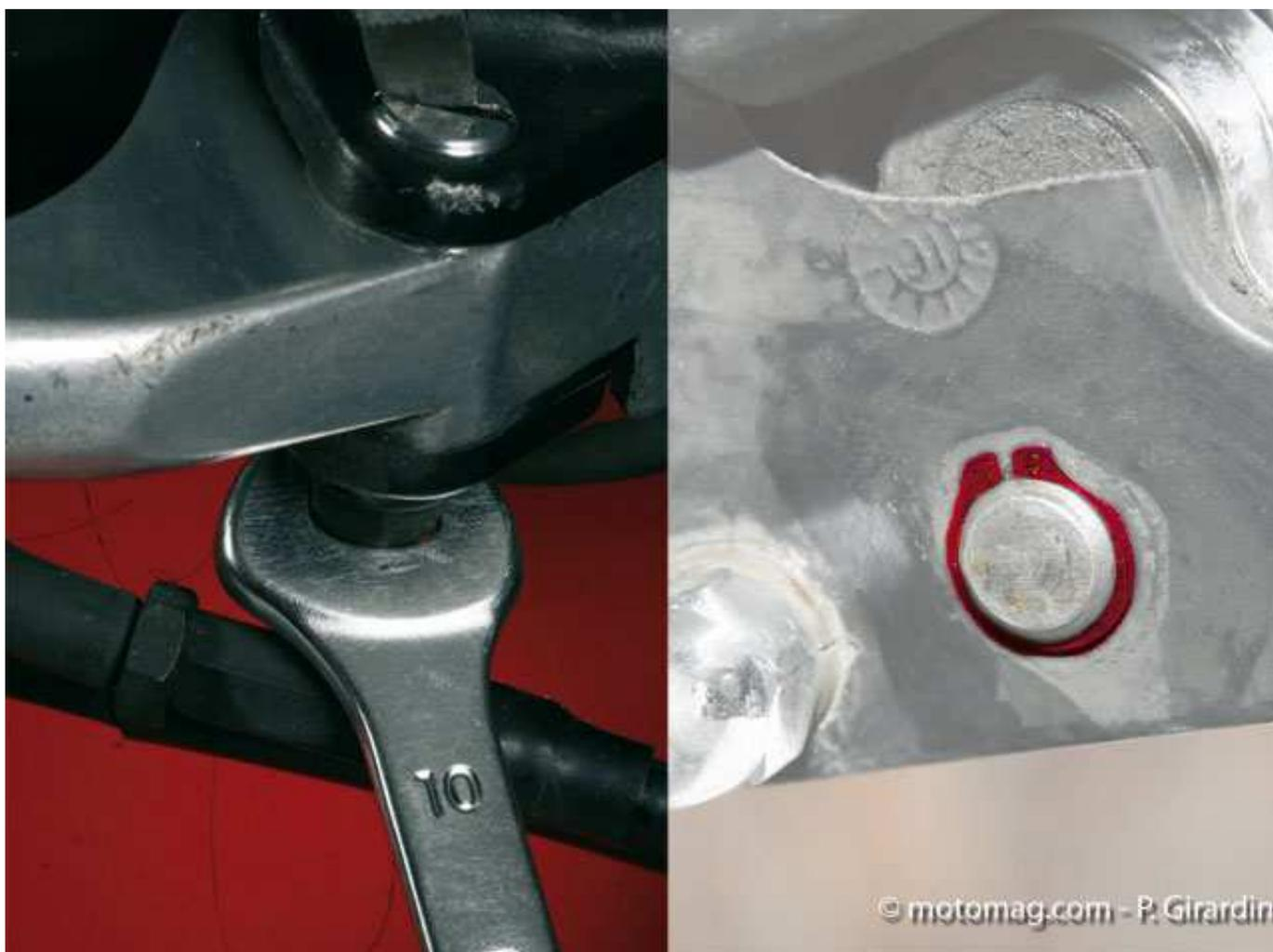
**2** Dans l'épaisseur de certains leviers de frein est parfois logé un petit ressort qui le ramène en position de repos. Au démontage, ce ressort peut rester dans la cocotte, mais aussi tomber à terre... Vérifiez sa présence au remontage. Une goutte de graisse facilite son maintien pendant le positionnement du levier neuf.
