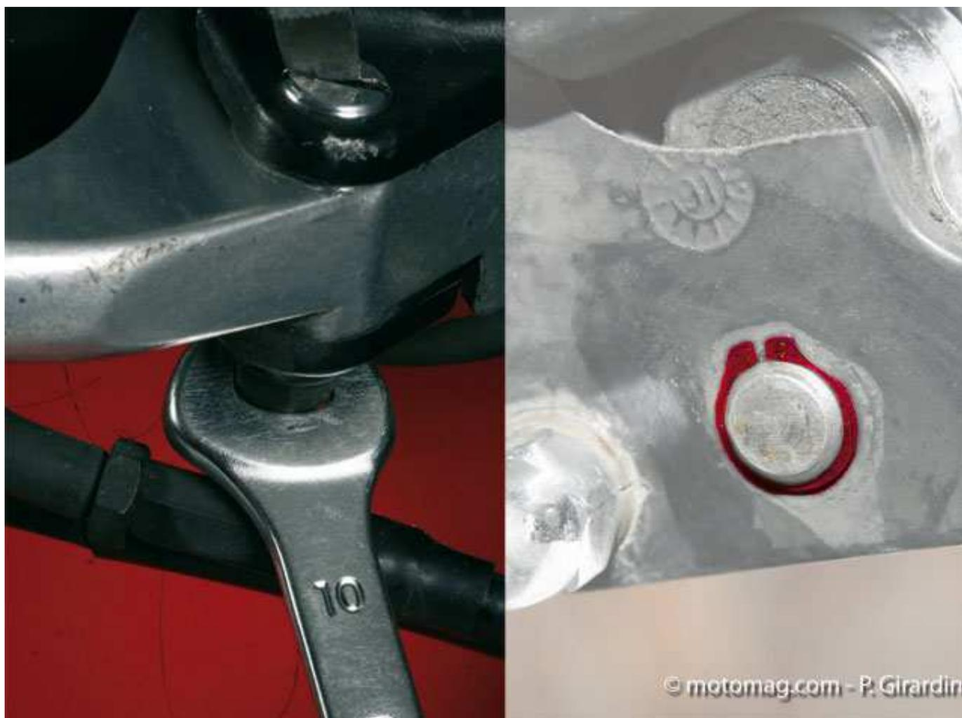
L'axe d'un levier est généralement constitué d'une vis, dont la tête est bien visible sur le dessus. Mais avant de la dévisser, il faut retirer son contre-écrou de sécurité, qui lui, est situé sous la « cocotte » (c'est le nom du support du levier) fixée au guidon. Parfois l'écrou est remplacé par un clip (en rouge sur la photo de droite)..
