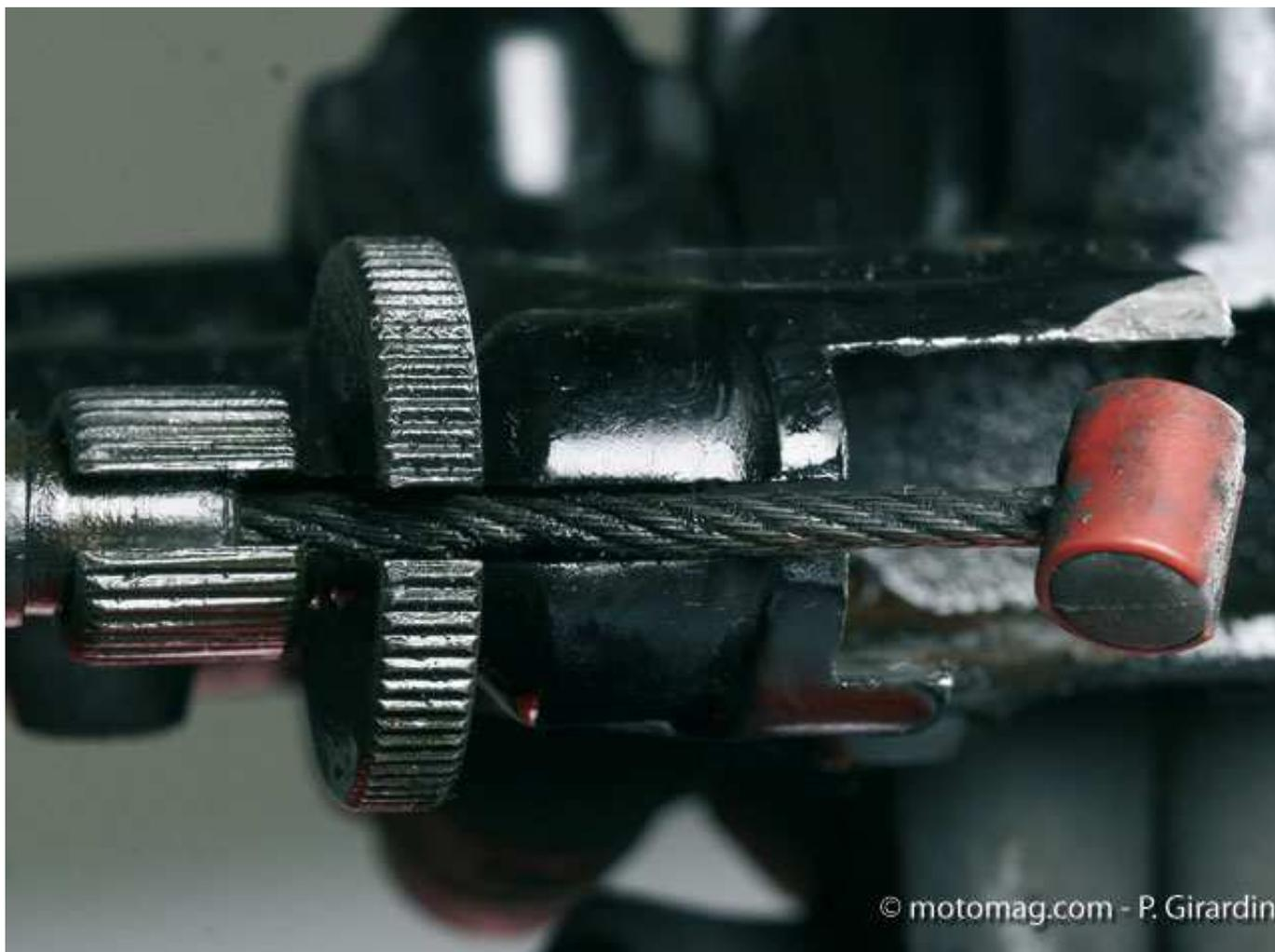
**4** Certains leviers de freins comportent ce type de vis, qui sert à ajuster la garde, c'est-à-dire le jeu nécessaire avant que le levier n'actionne le piston du maître-cylindre. Le réglage à ce niveau est primordial, car un manque de jeu ferait freiner en permanence.
